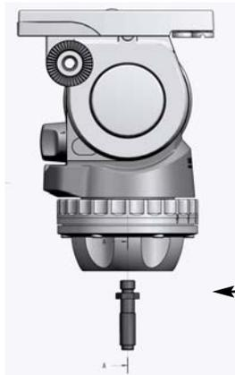
Um den FSB 4 mit Flachbodenanschluss verwenden zu können, muß der Gewindezapfen entfernt werden.
