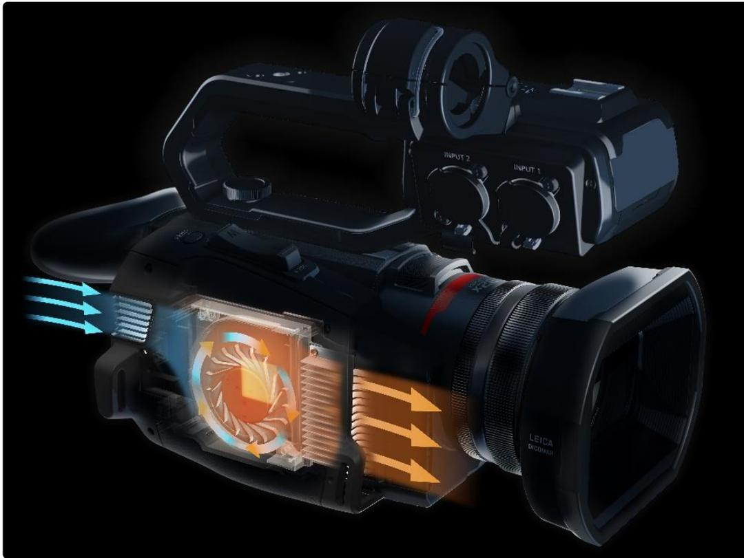
Der neu entwickelte und extrem flache Ventilator ermöglicht Kompaktheit und geringen Stromverbrauch.
